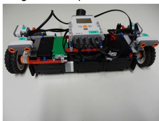
Die Logikgruppe ist zuständig für die Kommunikation der Gruppen, damit alle so programmieren, dass der Staubsauger vorwärts und rückwärts fahren kann, sich dreht und auch saugt. Außerdem
